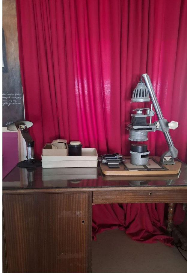
Görsel 2. Agrandizör (Fotoğrafi negatifinden büyüterek resim basmak için kullanılan makine)
